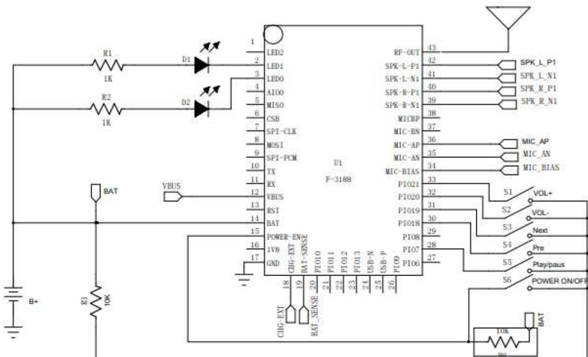
如若上电开机，侧用 R6的10K电阻接电池正极（如方框内）替代S6开关电路
